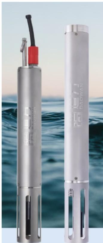
Гидрологические зонды Daowan используются для измерения трех основных параметров состояния морской воды (STD) - проводимости, температуры и давления/глубины, которые также позволяют рассчитывать соленость, плотность и скорость звука.
